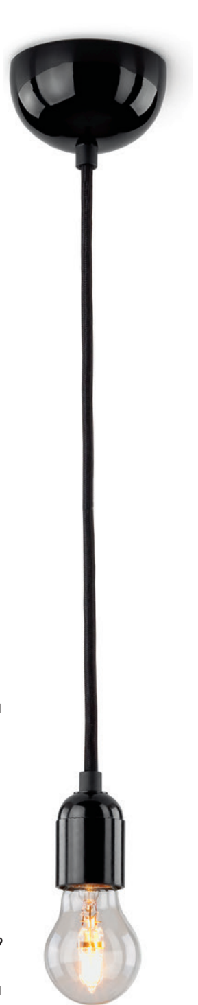
Hängeleuchte MINIMAL Bakelit mit Schirmaufnahme Schwarze Bakelitfassung mit Schirmaufnahme und 1,5 m langem schwarzen Textilkabel. E27, max. 60 W. Mit integrierter Zugentlastung. Bestell-Nr. 101191
