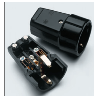
Kupplung Duroplast schwarz Schwarzes Duroplast. 250 V, 16 A, 50 Hz. Nur für Wechselstrom. Ø 50 mm. Länge 70 mm. Gewicht 68 g. Bestell-Nr. 139448
