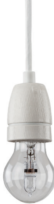
Hängeleuchte MINIMAL Porzellan weiß Weiße Porzellanfassung mit Klemmring und 1,5 m langem weißen Textilkabel. E27, max. 60 W. Gewicht 200 g. Mit Zugentlastung. Bestell-Nr. 101178
