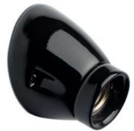
Wandfassung MINIMAL Porzellan schwarz Dreiteiliger Porzellansockel in angeschrägter Form. Ø max. 75 mm, Ausladung 85 mm. E27, max. 75 W. IP20. VDE-zertifiziert. Bestell-Nr. 152651
