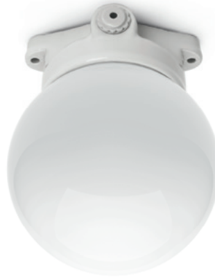
Deckenleuchte weiß L opal Ø Glas 180 mm, Höhe 230 mm. Gewicht 1300 g. E27, max. 100 W. IP54. Bestell-Nr. 100796
