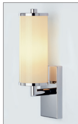
Wandleuchte Triplex-Opalglas einflammig Messing verchromt. Glaszylinder Ø 80 mm, Gesamthöhe 315 mm, Ausladung 115 mm. Wandbefestigung 80 mm x 150 mm. Gewicht 840 g. E14, max. 40 W. Bestell-Nr. 163946
