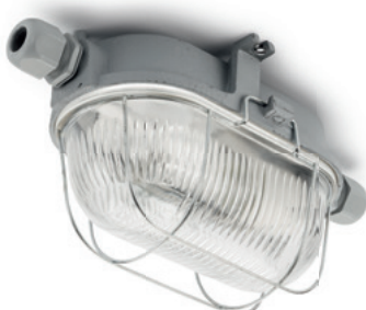
Kellerleuchte Gusseisen grau oval groß Länge 195 mm, Breite 135 mm, Höhe 115 mm. Gewicht 1700 g. Porzellanfassung E27, max. 100 W. IP54. Bestell-Nr. 100506
