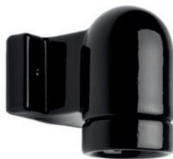
Winkelfassung MINIMAL Porzellan schwarz Dreiteiliger Porzellansockel in angewinkelter Form. Ø 65 mm, Höhe 80 mm, Ausladung 75 mm. E27, max. 75 W. IP20. VDE-zertifiziert. Bestell-Nr. 152650
