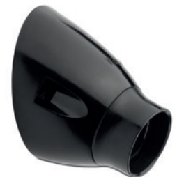
Wandfassung MINIMAL Bakelit® Dreiteiliger Bakelitsockel in angeschrägter Form. Ø max. 75 mm, Ausladung 85 mm. E27, max. 75 W. IP20. VDE-zertifiziert. Bestell-Nr. 153108
