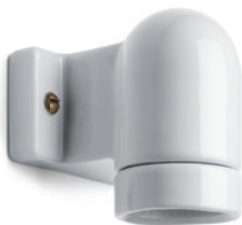
Winkelfassung MINIMAL Porzellan weiß Dreiteiliger Porzellansockel in angewinkelter Form. Ø 65 mm, Höhe 80 mm, Ausladung 75 mm. E27, max. 75 W. IP20. VDE-zertifiziert. Bestell-Nr. 152645
