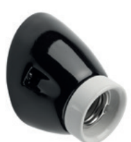
Wandfassung MINIMAL Porzellan schwarz, Klemmring weiß Porzellansockel in angeschrägter Form. Max. Ø 75 mm, Ausladung 85 mm. Gewicht 200 g. Bestell-Nr. 152656
