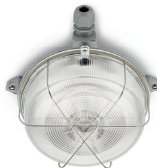
Kellerleuchte Gusseisen grau rund Ø 200 mm, Höhe 100 mm. Gewicht 2300 g. Porzellanfassung E27, max. 100 W. IP54. Bestell-Nr. 100502
