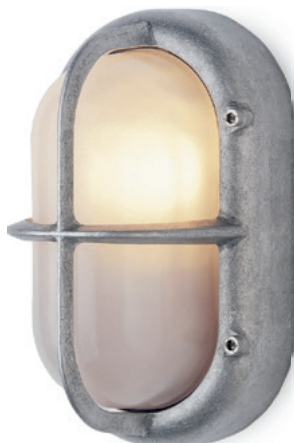
Wandleuchte Aluminium oval Länge 200 mm, Breite 110 mm, Tiefe 120 mm. Gewicht 900 g. Porzellanfassung E 27, max. 60 W. IP45. Bestell-Nr. 165250
