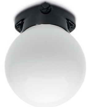
Deckenleuchte schwarz M opal Ø Glas 150 mm, Höhe 185 mm. Gewicht 870 g. E27, max. 75 W. IP54. Bestell-Nr. 101327
