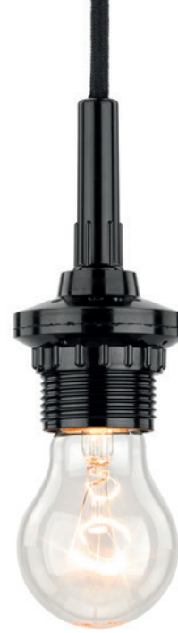
Hängeleuchte MINIMAL Bakelit mit Schirmaufnahme Schwarze Bakelitfassung mit Schirmaufnahme und 1,5 m langem schwarzen Textilkabel. E27, max. 60 W. Mit integrierter Zugentlastung. Bestell-Nr. 101191
