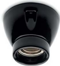
Deckenfassung MINIMAL Porzellan schwarz Dreiteiliger Porzellansockel in gerader Form. Ø max. 75 mm, Höhe 60 mm. E27, max. 75 W. IP20. VDE-zertifiziert. Bestell-Nr. 152649
