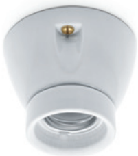
Deckenfassung MINIMAL Porzellan weiß Dreiteiliger Porzellansockel in gerader Form. Ø max. 75 mm, Höhe 60 mm. E27, max. 75 W. IP20. VDE-zertifiziert. Bestell-Nr. 152643
