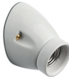
Wandfassung MINIMAL Porzellan weiß Dreiteiliger Porzellansockel in angeschrägter Form. Ø max. 75 mm, Ausladung 85 mm. E27, max. 75 W. IP20. VDE-zertifiziert. Bestell-Nr. 152647
