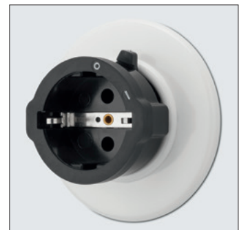
Zwischenstecker schaltbar Duroplast schwarz Schwarzes Duroplast. 230 V, 16 A, 50 Hz. Nur für Wechselstrom. Ø 50 mm. Länge 45 mm. Gewicht 50 g. Bestell-Nr. 100477
