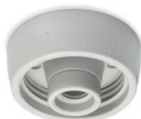
Deckensockel THPG Porzellan M Ø 108 mm, Höhe 60 mm. Bestell-Nr. 177026
