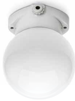
Deckenleuchte LISILUX weiß M Kugel opal Ø Glas 150 mm, Höhe 185 mm. Gewicht 870 g. E27, max. 75 W. IP54. Bestell-Nr. 100795
